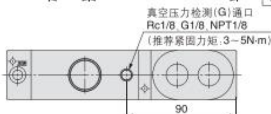
带真空压力检测通口规格
